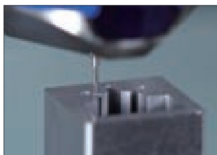
MPP-NANO的模具扫描测量
