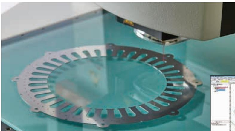
EV 车用电机铁芯的轮廓形状测量
