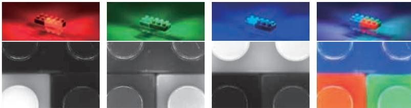
利用模拟彩色影像显示功能，可以从RGB各个照射图像生成颜色再现性高的彩色观察图像。
